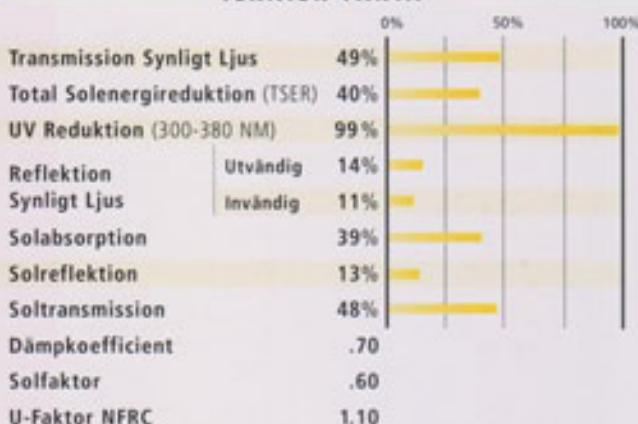
Testresultatens värden är beräknade efter installation på insida av 3 mm "Starphire" klart enkelglas.
